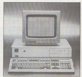
Η κεντρική μνήμη του μηχανήματος είναι 2MB, αποτελούμενη από chips δυναμικής μνήμης (DRAM) των 256Kb. Επιπρόσθετα μπορούν να τοποθετηθούν 2MB μνήμης, χρησιμοποιώντας τα παραπάνω chips. Συνολικά η RAM μπορεί να επεκταθεί έως τα 16MB, με chips του 1Mb. Η περιφερειακή μνήμη αποτελείται από ένα floppy disk 3,5 ιντσών των 1,44MB, ενώ μπορεί να τοποθετηθεί ένα ακόμη εσωτερικό
